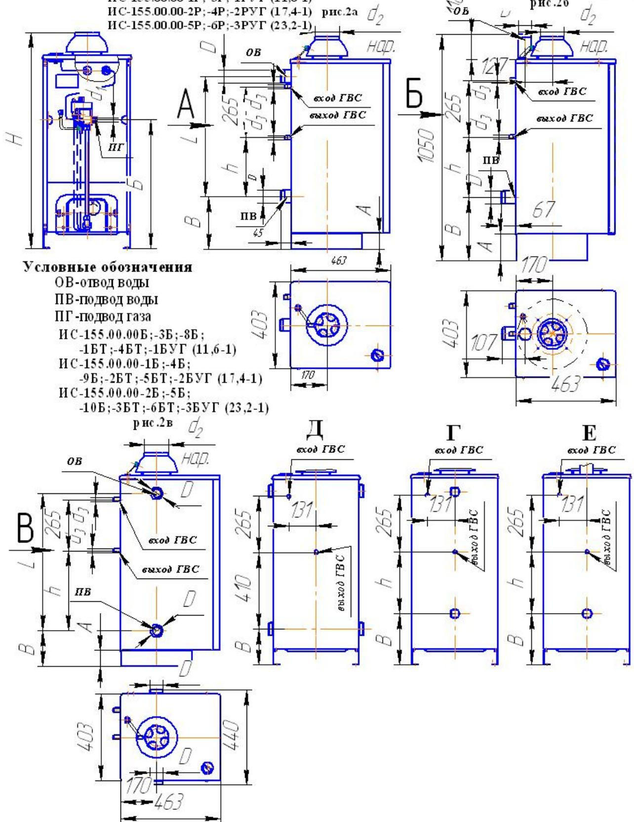
Таблица габаритных и присоединительных размеров АКТВ к рис.2
